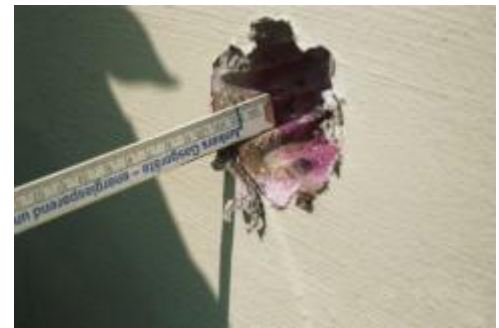
Karbonatisierungsbestimmung mit Phenolphthalein
